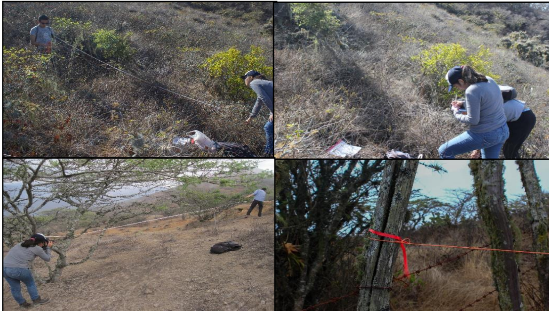
Ilustración 24: Medido de parcelas, toma de coordenadas y marcado de vértices con cinta roja en las parcelas.
